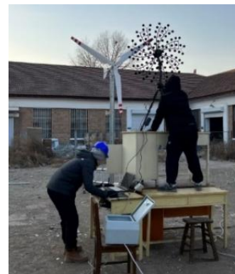
覆冰叶片的气动声学测试试验现场及测试结果
