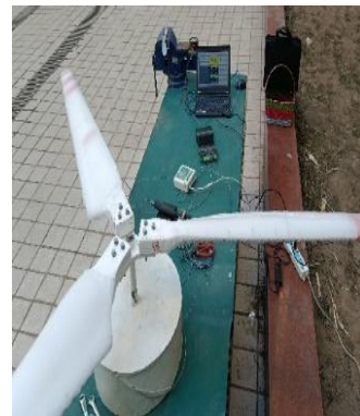
覆冰叶片的结构动力学测试试验现场及测试结果
